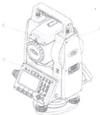
Схема пломбирования тахеометров электронных 6ТаЗ от несанкционированного доступа
