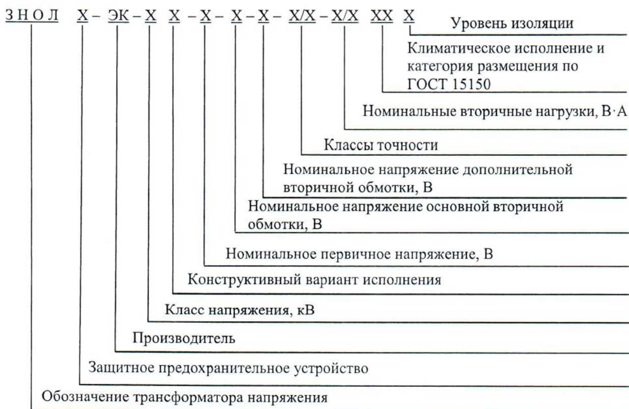
Рисунок 1 – Расшифровка условного обозначения трансформаторов напряжения
