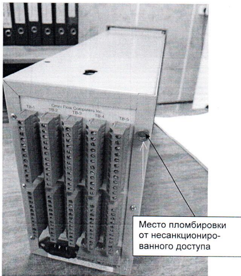
Рисунок 3.2 – Место пломбировки на задней поверхности
